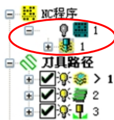
图 7-49 由刀具路径 1 生成的 NC 程序
