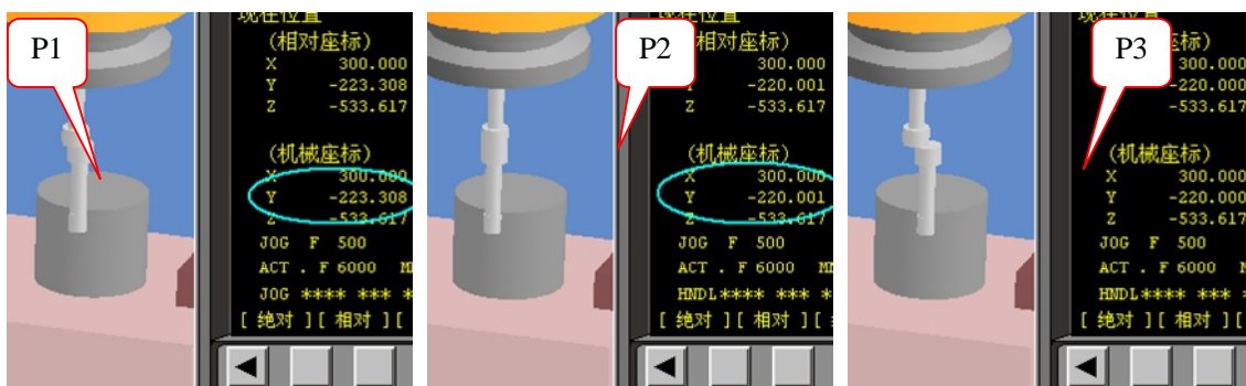
图 4-19 确定 Y 轴右边的基准值
