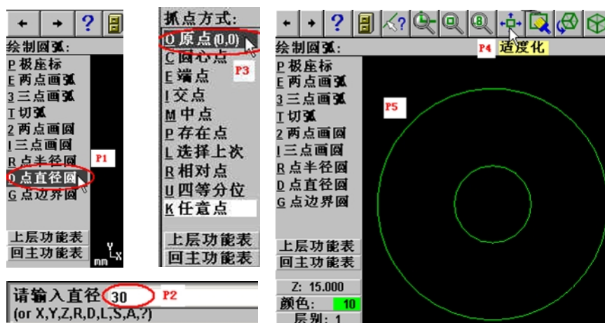
图 5-7 绘制 \Phi 30 的凹槽
