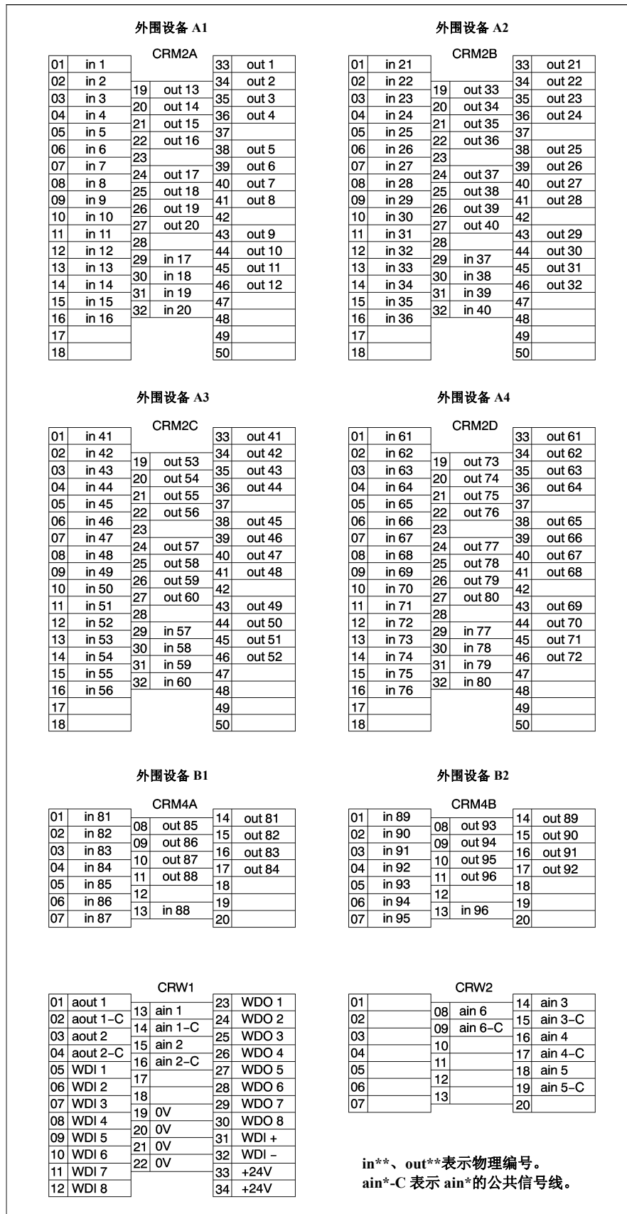
图 3.1(c) 处理 I/O 印刷电路板的接口
