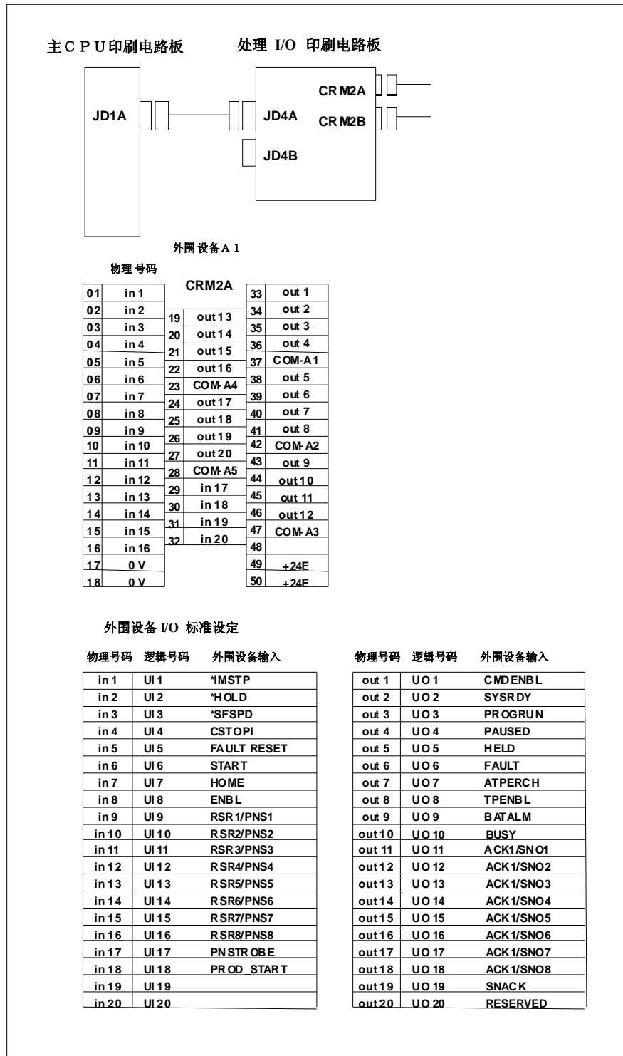
图 3.3(a) 外围设备 I/O 的接口
