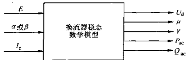
图 3-3 换流器稳态数学模型的输入输出关系
