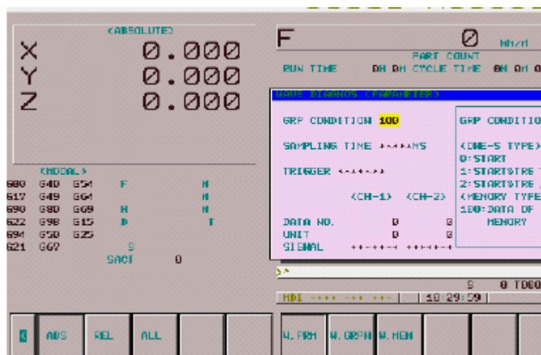
如果在起动时，波形不光滑，则表示伺服增益不够，需要再提高。如果在中间的直线上有波动，则可能由于高增益引起的震动，这可通过设定参数 2066=-10（增加伺服电流环 250um）来改变，如果还有震动，可调整画面中的滤波器值(参数 2067)=2000 左右，再按上述步骤调整。
