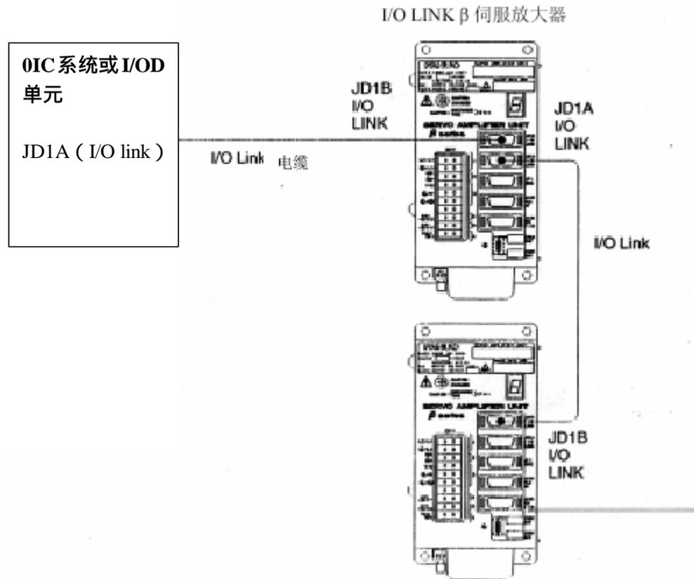
\* 每个轴占用 16 字节输入/16 字节输出点 (128/128 点) FANUC 的 I/O Link 的最大点数为 1024/1024 ,
