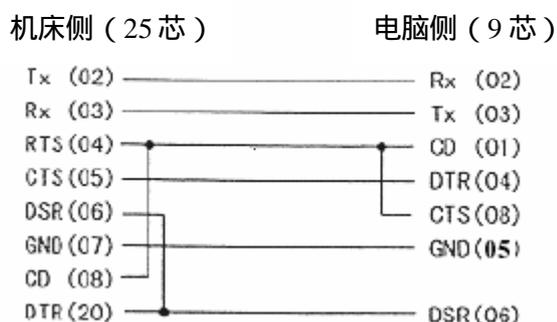
2. 为防止电脑的串口漏电对 NC 的接口烧坏,要在接口上加光电隔离器。最好是不用 232 口,使用存储卡接口更方便,且不会烧坏接口。
