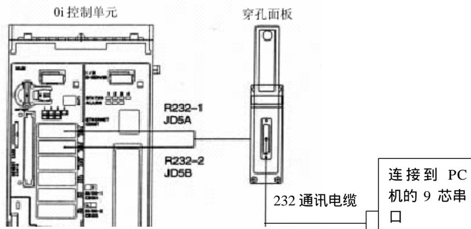
注：1. 上图中的 232 通讯电缆需要由用户自己焊接,推荐的接线图如下:
