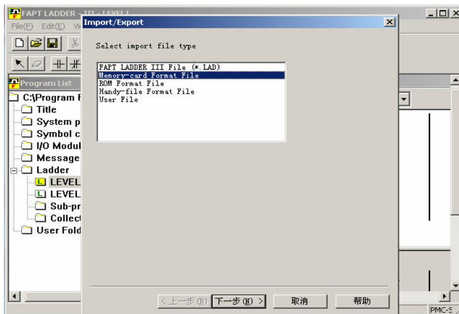
执行下一步找到要进行转换的 M-CARD 格式文件 按照软件提示的默认操作一步步执行即可将 M-CARD 格式的 PMC 程序转换成计算机可直接识别的.LAD 格式文件，这样就可以在计算机上进行修改和编辑操作了。
