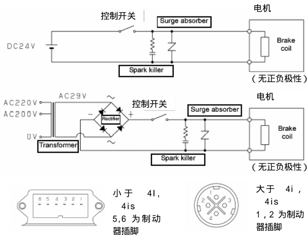
注：上图中的 Switch 为 I/O 输出点的继电器触点 (常开)，控制制动器的开闭。
