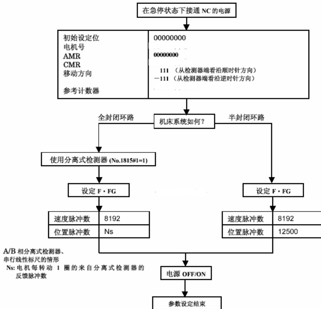
上述的流程图左边为全闭环的设定步骤，要注意的是 CMR, N/M, 位置脉冲数，如果设定错误，有时候轴可以走，并且移动的距离也正确，但会加大振动，例如：
