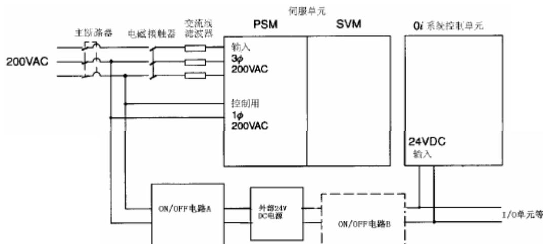
通电前,断开所有断路器,用万用表测量各个电压(交流 200V,直流 24V)正常之后,再依次接通系统 24V, 伺服控制电源(PSM)200V, 24V( i)。最后接通伺服主回路电源(3 相 200V)。
