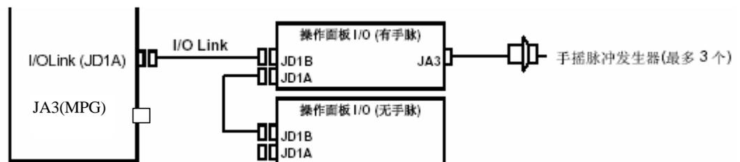
注意：对于手脉接口，OiC 在控制器的内装 I/O 卡上或操作面板 I/O 上都有，而 Oi-mate C 只有在操作面板 I/O 上才有。
