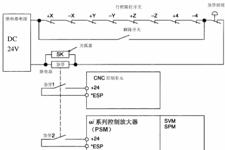
注意：上述图中的急停继电器的第一个触点接到 NC 的急停输入 (X8.4)，第二个触点接到放大器的电源模块的 CX3 (1, 3)。对于 is 单轴放大器，接第一个放大器的 CX30(1,3 脚)，注意第一个 CX19B 的急停不要接线。
