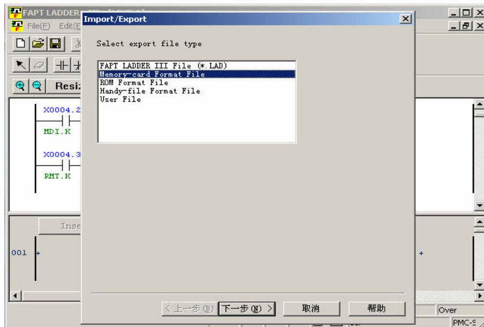
确定 **M-CARD** 格式后，选择下一步指定文件名，按照软件提示的默认操作即可得到转换了格式的 **PMC** 程序，注意该程序的图标是一个 **WINDOWS** 图标（即操作系统不能识别的文件格式，只有 **FANUC** 系统才能识别）。
