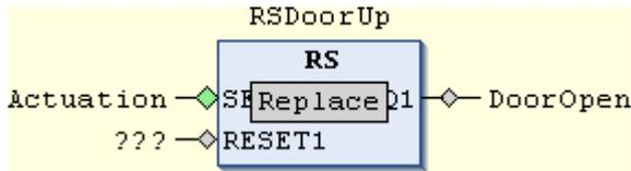
由于有三种可能的原因停止车库门打开的过程，所以我们放置一个 OR 操作符（3 输入）在 RS 功能块的 RESET1 输入端。三种可能的原因被连在 OR 操作符的输入端：DoorOpen 传感器报告车库门已经到达它的最高位置。这个变量已经被声明，可以直接连接到 OR 操作符的输入端。用户按下控制按钮的同时，执行部件 DoorUp 被激活。通过插入一个 AND 操作符（2 输入），连接控制按钮变量 Actuation（带有沿检测），变量 DoorUp 连接到操作符的输入端，来查询这种情形。由于驱动过载，或者过长时间的 Door-up 或者 Door-down 都会引起错误。这个错误需要用到第二个附加变量，并且在自动声明的对话框中声明为一个布尔变量。
