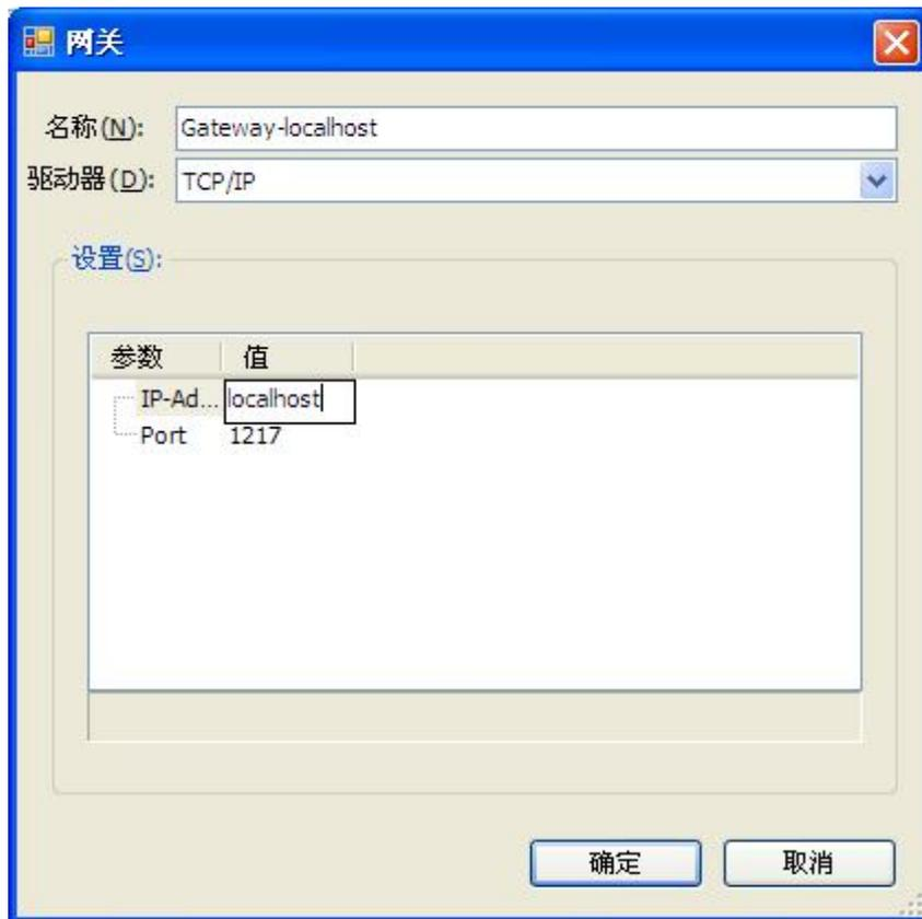
为网关输入名称，驱动器选择“TCP/IP”，IP 地址设置为“local host”（鼠标双击相应列，打开编辑框），端口不用设置，点击“确定”关闭对话框。
