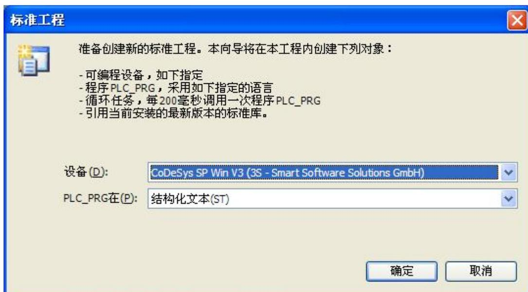
设备选择“**CoDeSys SP Win V3 (3S-Smart Software Solutions GmbH)**”，PLC\_PRG 的编程语言选择“**结构化文本(ST)**”。点击“**确定**”保存配置。
