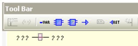
变量 Actuation 写到任务的输入端，它的值分配给变量 Error。但是在这个案例中，变量 Error 必须可以重置，所以我们必须在输出端设置“Reset”R (从工具条中拖出，或者使用鼠标右键，或者使用组合键“Ctrl+M”)。
